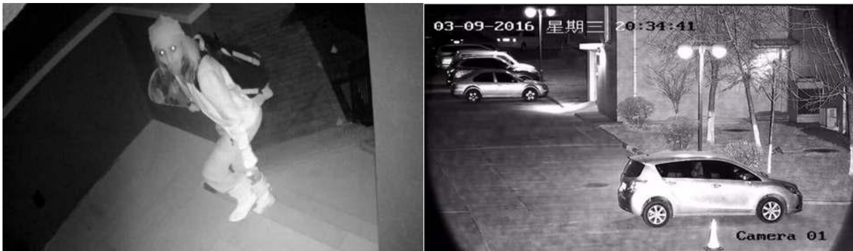
Imágenes de cámaras de CCTV con iluminadores infrarrojo. La calidad de imagen y resolución permiten aplicar analíticas con gran eficiencia
