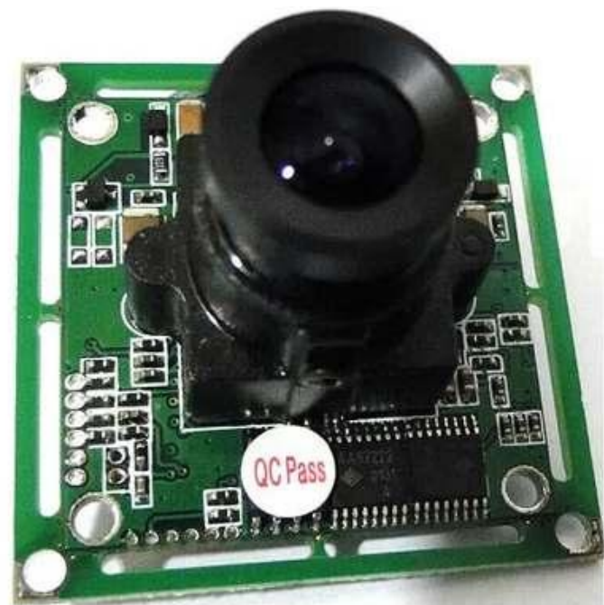
LENTE OPTICO MONTADO SOBRE UNA PLACA CON SENSOR DE IMAGEN
